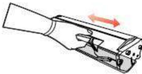
5. 取下雷射碳粉盒保護罩（吸塑罩），將雷射碳粉盒沿著導軌放入印表機，沿著箭頭方向按壓 直至聽到“啞啞”聲音後，完成安裝。
